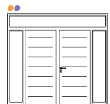
2 VANTAUX ÉGAUX + DOUBLE FIXE EN DORMANT + IMPOSTE VITRÉE
